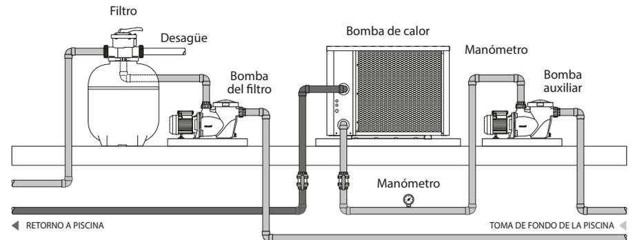
1. La bomba de calor debe ser instalada en un lugar con buena ventilación, respetando las medidas del siguiente gráfico:
