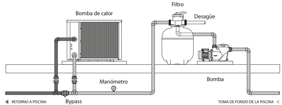
Esquema de instalación hidráulico con circuito independiente (recomendado):
